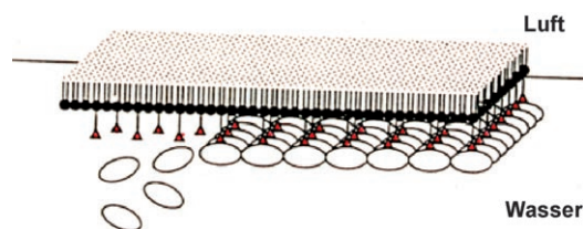
Abbildung 4. Zweidimensionale Proteinkristallisation an Lipidschichten. Proteine (ovale Symbole) binden an die Kopfgruppen (rote Dreiecke) von Lipidmolekülen, die eine Monoschicht an der Luft-Wasser-Grenzfläche bilden. Die schnelle laterale Diffusion der Lipide führt zur Proteinkristallisation.
